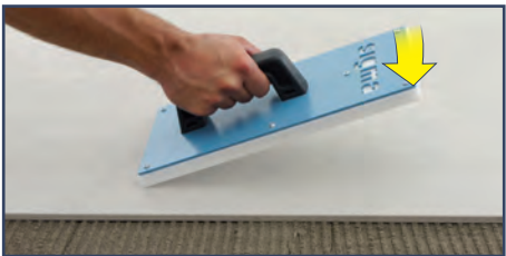
Fratteggio Battipastrelle 16x33 cm, specifico per la corretta espulsione dell'aria da sotto la piastrella.
