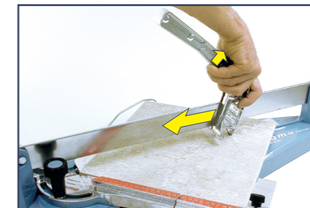
2B3 Incisione a trazione 2B3 Pulling incision system
