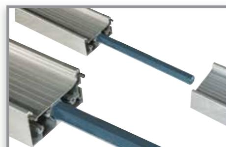
■ Il giunto di collegamento in acciaio esagonale da 19 mm di spessore e 480 mm di lunghezza, garantisce grande rigidità e rettilinearità dei profili estrusi assemblati
